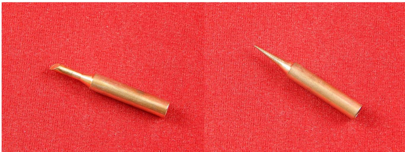
Рабочая часть паяльника называется жалом. Данное жало является сменным и процесс его установки достаточно прост. Для этого нужно просто выключить паяльник, вытянуть установленное жало и вставить в ручку другое. Далее можно включать паяльник и через очень небольшой промежуток времени продолжать работу.
