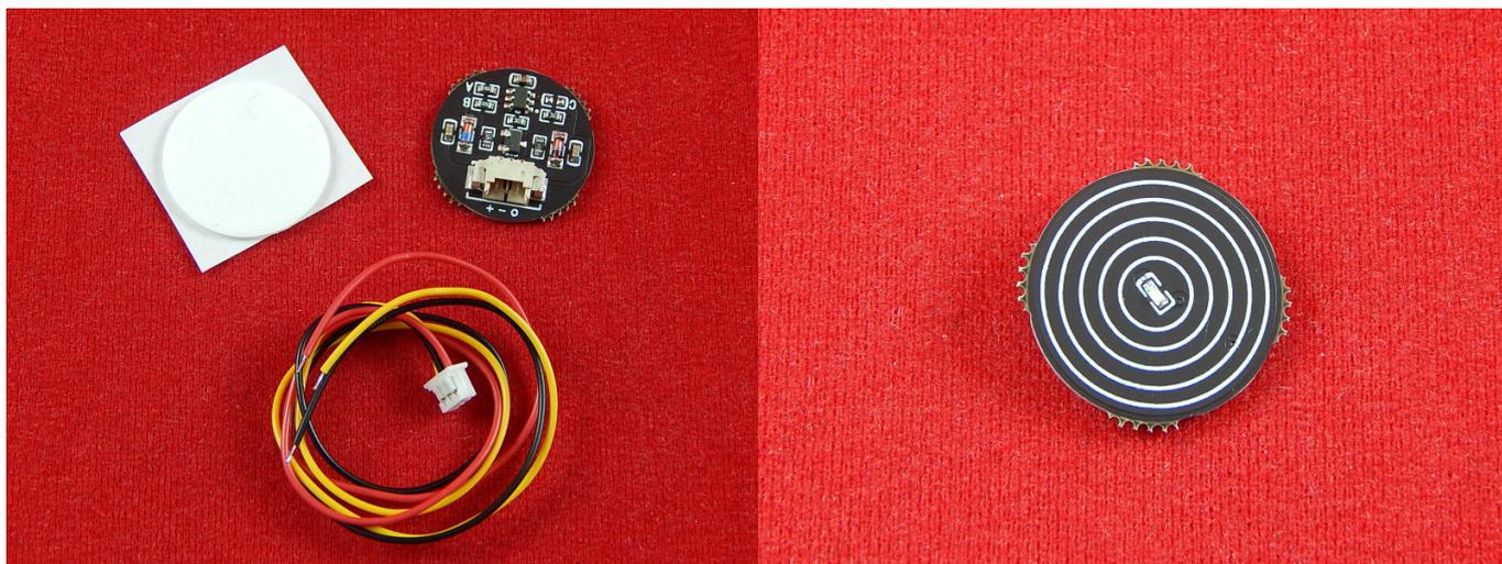
Сенсорная кнопка - это плата с проводящей поверхностью и контроллером, который измеряет емкость накопленного электрического заряда. При неизменных условиях внешней среды емкость сенсора не меняется. Но когда к нему подносится палец, его емкость увеличивается.
