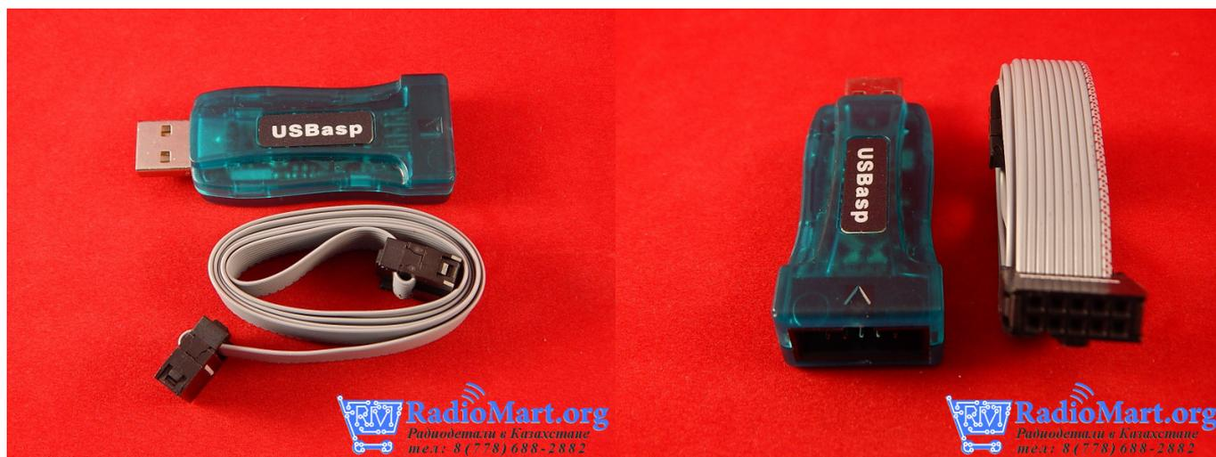
Программатор AVR USBASP позволит радиолюбителю получить простой, компактный и надежный программатор всех микроконтроллеров семейства AVR компании ATMEL с режимом последовательного программирования.
