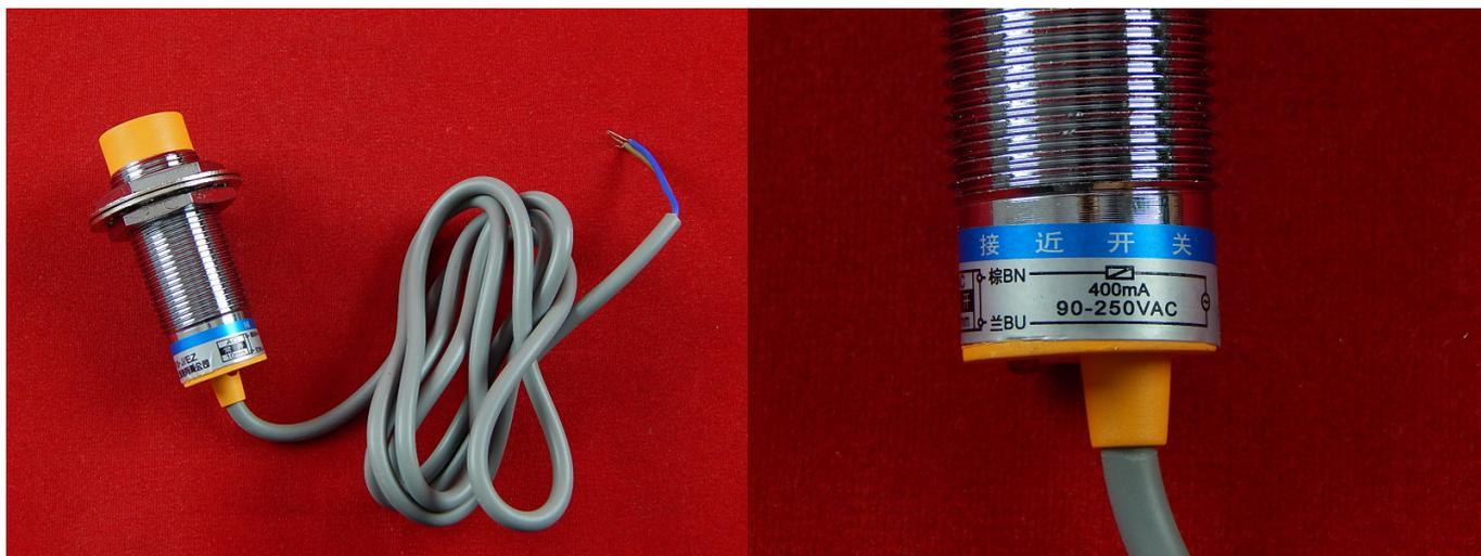
Индуктивный датчик LJ24A3-10-J/EZ предназначен для бесконтактного контроля положения предметов изготовленных из электро- и/или магнетопроводных материалов. Без физического контакта и вне зависимости от формы, индукционный бесконтактный датчик обнаруживает все предметы из цветных и черных металлов, находящиеся в пределах активной зоны, и выдает соответствующий управляющий сигнал.
