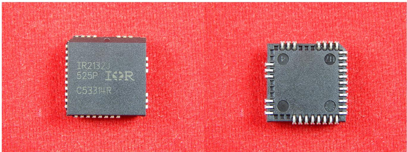
IR2132J является высоковольтным, высокоскоростным драйвером MOSFET и IGBT с тремя независимыми каналами выхода с высокой и низкой боковой привязкой. Запатентованная технология HVIC обеспечивает прочную монолитную конструкцию. Логические входы совместимы с выходами CMOS или LSTTL, вплоть до 2.5 В логики. IR2132J с корпусом PLCC-44 без 12 выводов.
