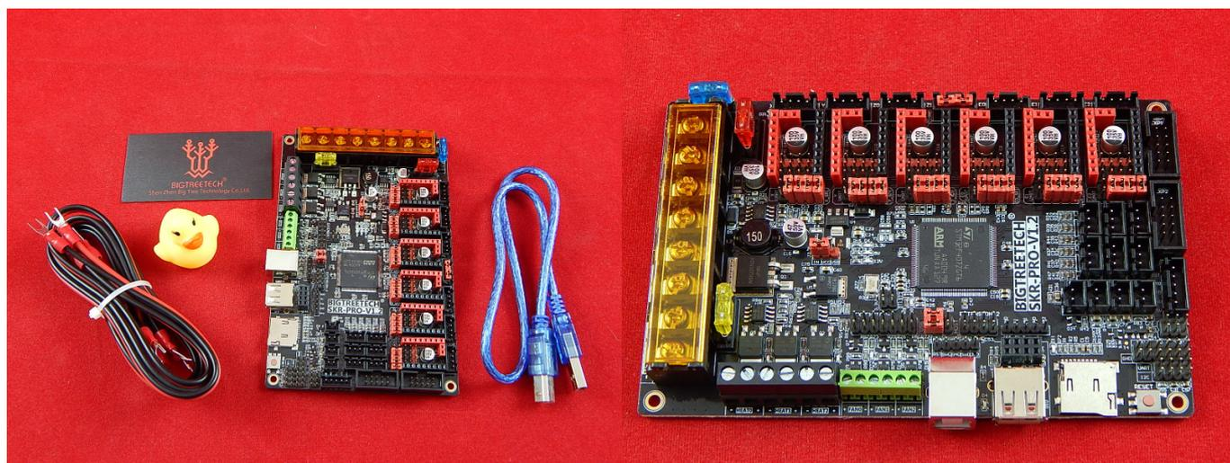
Bigtreetech SKR PRO - плата управления на 32 битном чипе ARM Cortex M4 "STM32F407ZGT6". Легко может быть использована в любых сборках 3D принтеров. Работает с прошивкой Marlin 2.0 с открытым исходным кодом.
