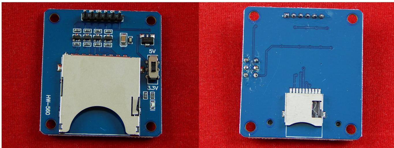
Модуль чтения записи MicroSD TF используется для подключения карт памяти (записи, чтения и хранения данных) в проектах на микроконтроллерах.
