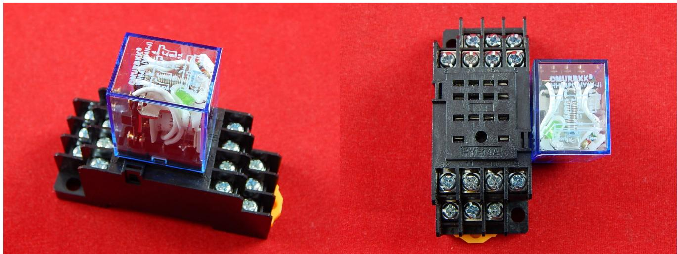
Электромагнитное реле это устройство для размыкания или смыкания контактов при поступлении в обмотку катушки реле электрического тока, порождающего электромагнитное поле которое перемещает якорь реле, связанный механическим способом с контактами которые передвигая размыкают или замыкают электрическую цепь
