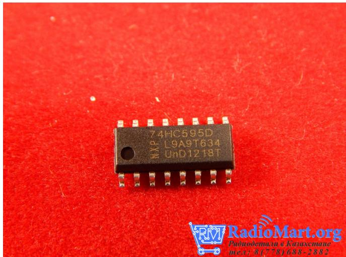
74HC595D, 8-и битный сдвиговый регистр с выходным регистром-защелки и тремя состояниями в корпусе SOP-16
