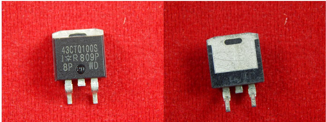
Диод — двухэлектродный электронный компонент, обладающий различной электрической проводимостью в зависимости от полярности приложенного к диоду напряжения.
