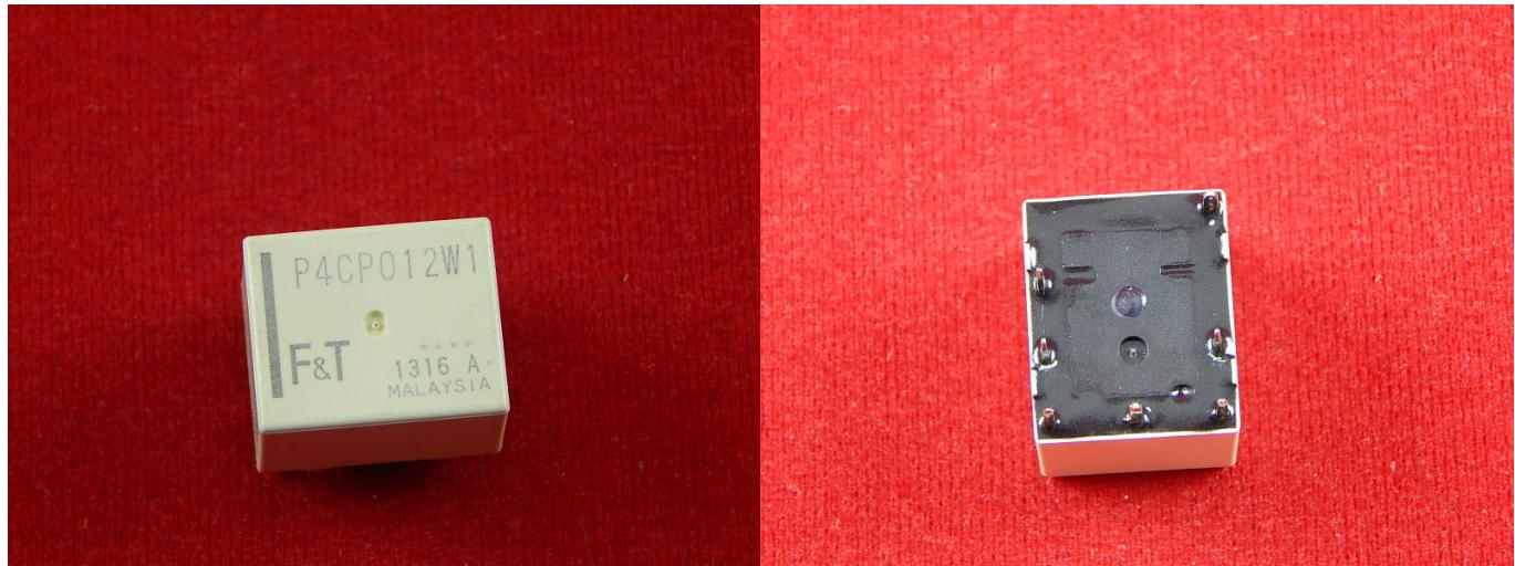
Реле — коммутационный аппарат, который при воздействии на него внешних физических явлений скачкообразно принимает конечное число значений выходной величины.
