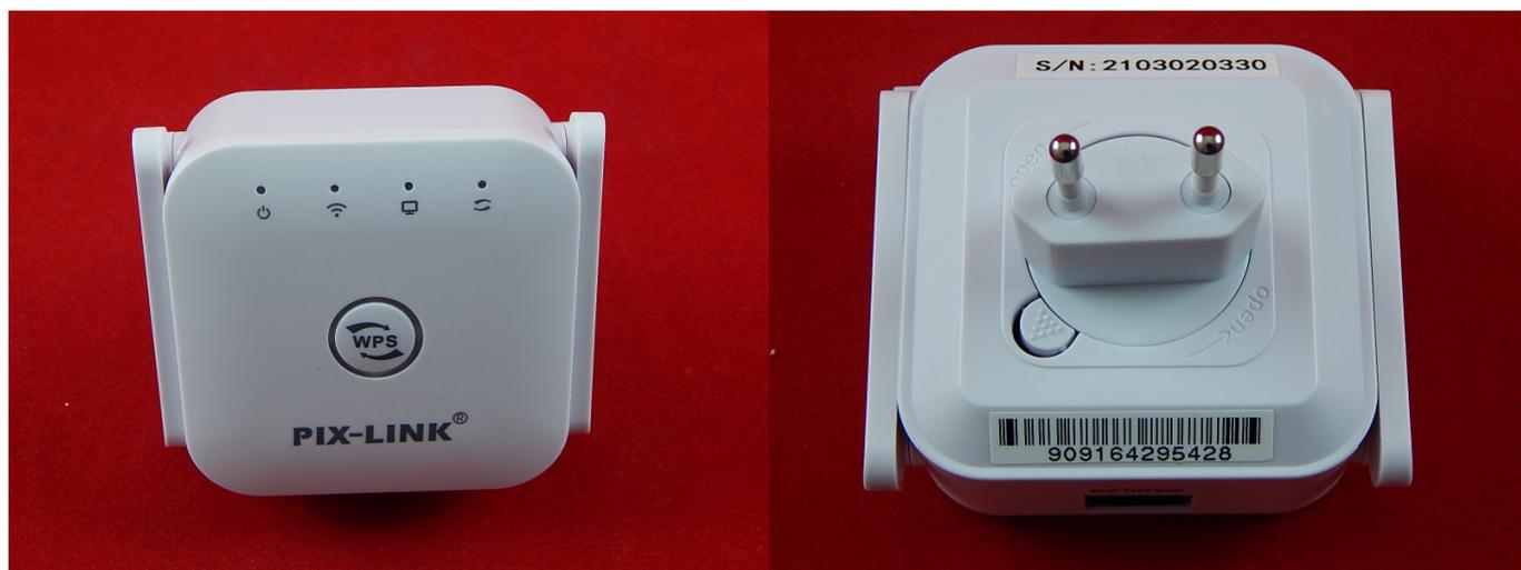
Репитер - усилитель беспроводного сигнала, предназначенный для расширения зоны покрытия беспроводной сети и увеличения мощности беспроводного сигнала, а также для устранения "мертвых зон". Проще говоря, Wi-Fi репитер усиливает вашу, уже существующую Wi-Fi сеть.
