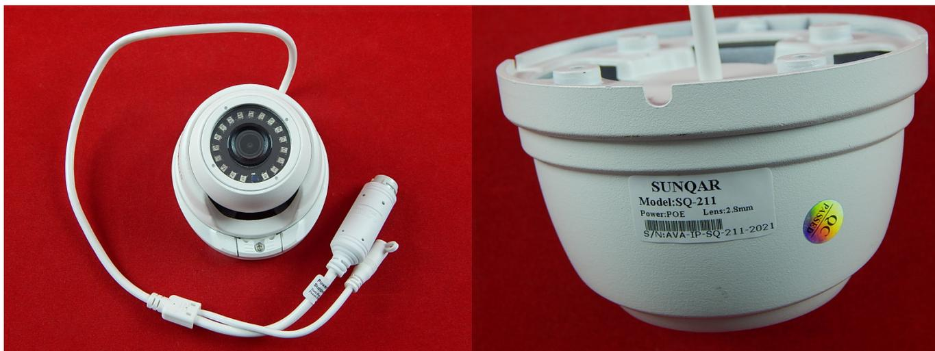
Антивандальная видеокамера - это видеокамера, защищенная специальным корпусом (обычно материал корпуса - поликарбонат) и специальным кожухом с металлическим основанием, который обеспечивает дополнительную прочность и надежность конструкции.
