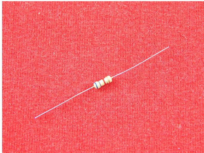
Резистор - это пассивный элемент электрических цепей, обладающий определённым или переменным значением электрического сопротивления, предназначенный для линейного преобразования силы тока в напряжение и напряжения в силу тока, ограничения тока, поглощения электрической энергии и другого.
