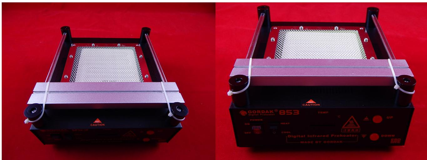
Платформа для нагрева печатных плат снизу при демонтаже (монтаже) электронных компонентов. В отличие от термовоздушных подогревателей, в которых тепло передается посредством контакта платы с теплоносителем (горячим воздухом), в этой конструкции используется прямой нагрев - то есть передача тепловой энергии от нагревательного элемента потоком инфракрасного излучения длинноволнового поддиапазона.
