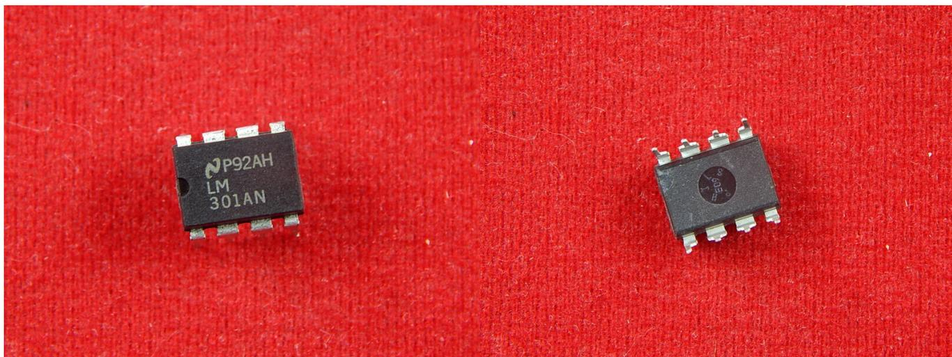
Операционный усилитель - это электронный усилитель напряжения с высоким коэффициентом усиления, имеющий дифференциальный вход и обычно один выход. Напряжение на выходе может превышать разность напряжений на входах в сотни или даже тысячи раз.
