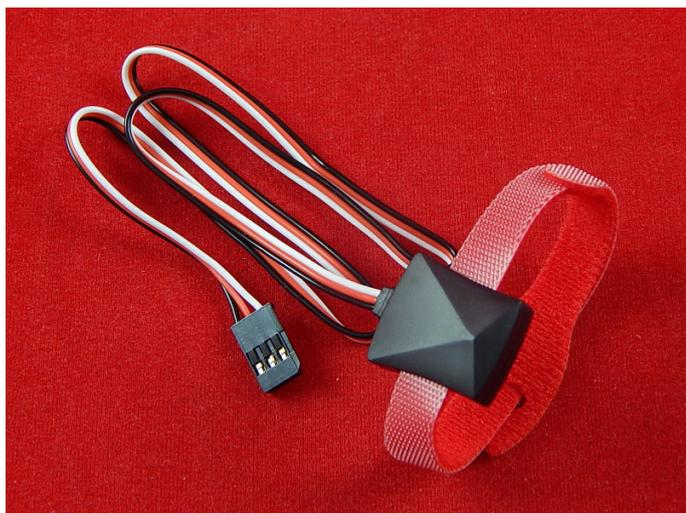
SkyRC Temperature Sensor (SK-600040-01) - температурный сенсор для измерения температуры аккумуляторов во время заряда и разряда. Используется с зарядными устройствами SkyRC, оборудованными портом для подключения температурного датчика.
