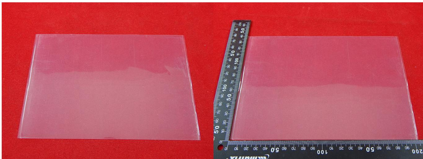
FER-пленки используются в фотополимерных принтерах. Они выступают барьером между смолой и дисплеем для засветки слоев. Пленка надежно закрепляется в рамке и хорошо пропускает любые виды излучения. Со временем пленка может мутнеть, что влияет на качество печати. Поэтому следует регулярно следить за ее состоянием и вовремя заменять старую пленку на новую.
