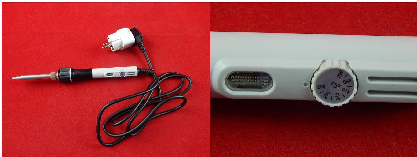
Паяльник — это прибор или инструмент, который служит для соединения деталей (проводов, контактов) посредством пайки, то есть добавления промежуточного металла или сплава между ними путём его расплавления, а затем остывания соединительного материала, называемого припоем.
