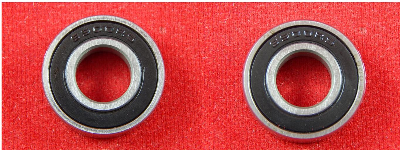
Подшипник — сборочный узел, являющийся частью опоры или упора и поддерживающий вал, ось или иную подвижную конструкцию с заданной жёсткостью. Фиксирует положение в пространстве, обеспечивает вращение, качение с наименьшим сопротивлением, воспринимает и передаёт нагрузку от подвижного узла на другие части конструкции. Его внутренний диаметр 10 мм, а внешний 22 мм. Высота подшипника 6 мм.
