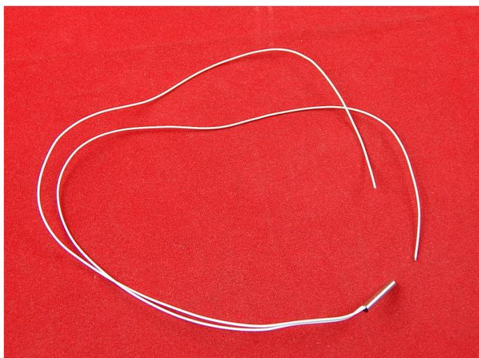
Датчик температуры для экструдера 3D принтера с кабелем 500 мм. Из-за очень большого изменения сопротивления датчик рекомендуется применять в задачах, в которых диапазон измерения не более чем 50-100°C (например, от 200°C до 280°C).
