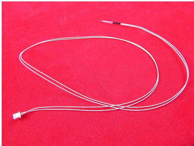
Датчик температуры для экструдера 3D принтера с кабелем 1м. Из-за очень большого изменения сопротивления датчик рекомендуется применять в задачах, в которых диапазон измерения не более чем 50-100°C (например, от 200°C до 280°C). Так же имеющий 2pin разъем для подключения к плате.
