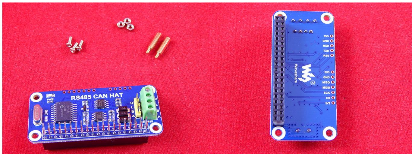
**RS485 CAN HAT for Raspberry Pi** - плата расширения от **Waveshare** для [Raspberry Pi](#), добавляющая интерфейс RS485, что позволит взаимодействовать RPi с другими устройствами посредством указанного интерфейса.
