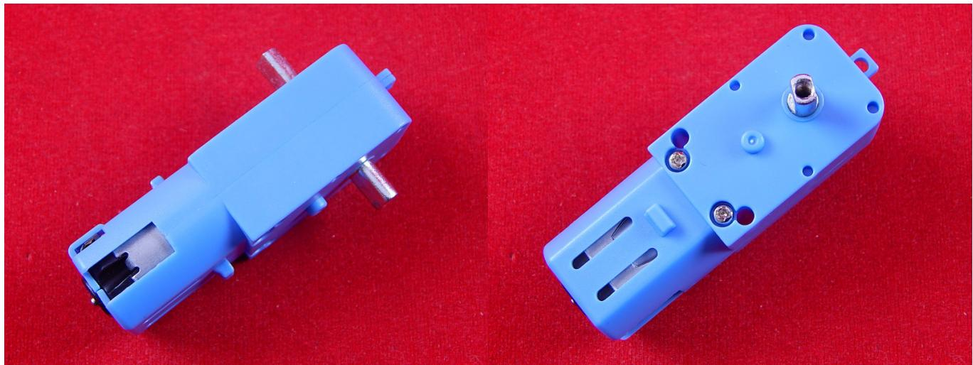
Двухосный двигатель с редуктором идеально подходящий для конструирования небольших движущихся конструкций. Двигатель типа ТТ с металлическим редуктором 1:90. Подойдет для колесных роботов весом до 1 кг.
