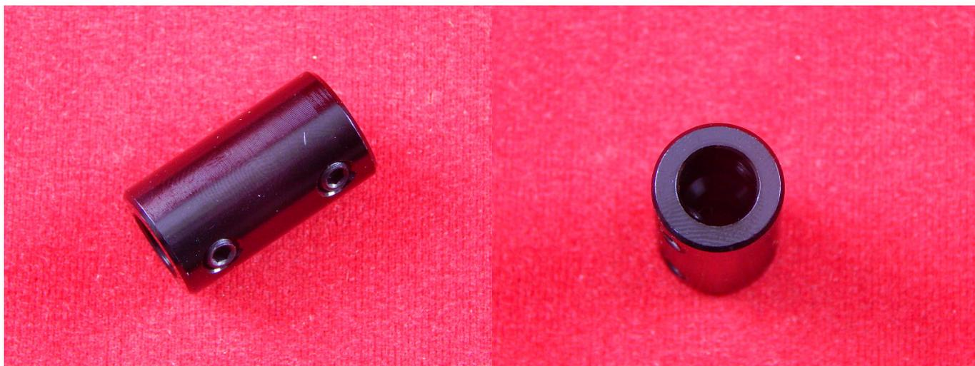
Жесткая соединительная муфта из алюминиевого сплава используется для передачи крутящего момента от вала электродвигателя к валу передачи. Фиксация на вал осуществляется при помощи винта.
