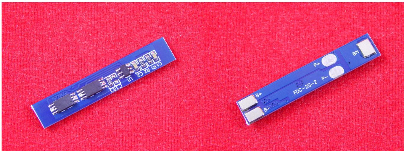
Контроллер BMS (Battery Management System) заряда, разряда, защиты для двух последовательно соединенных литиевых аккумуляторов 2S Li-Ion или Li-POL 7.4V - 8.4V с максимальным током нагрузки 3А и кратковременно до 5А. Позволяет осуществлять заряд двух последовательно соединенных литиевых элементов, а также контролирует их разряд во время нагрузки.
