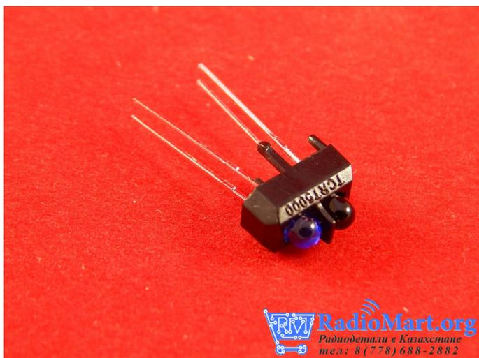
Этот датчик испускает инфракрасный сигнал и затем ловит отражение этого инфракрасного сигнала от поверхности.
