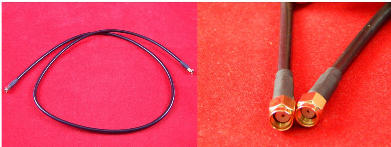
RP (reverse polarity) SMA - это разъем обратной полярности. Соединители RP-SMA специально разработаны несовместимыми с SMA, чтобы предотвратить ошибочные или несанкционированные соединения (например, подключение слишком сильной антенны). Обратите внимание, в данном случае термин **reverse polarity по сути обозначает «смену пола»** разъема, а не изменение полярности сигнала.
