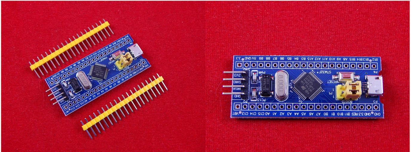
Отладочная плата F103C8T6 на базе STM32 по параметрам значительно опережает аналогичные по размеру Arduino Nano или Leonardo, а по скорости близка к Arduino DUE. Так же теперь есть возможность заливать скетчи через Arduino IDE.
