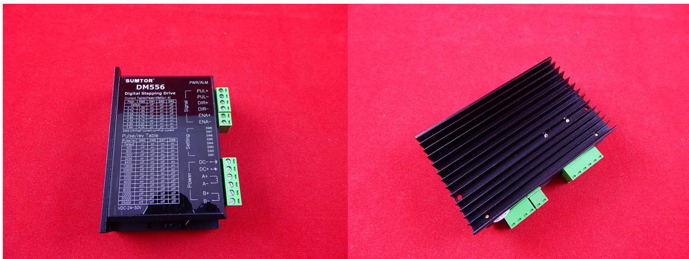
Блок управления для шаговых двигателей от 17 до 34 мм. Ток фазы до 4.2 А, напряжение питания до 50 В. Функции подавления резонанса, защита от КЗ, превышения питающего напряжения. Частота входного сигнала до 200 кГц.
