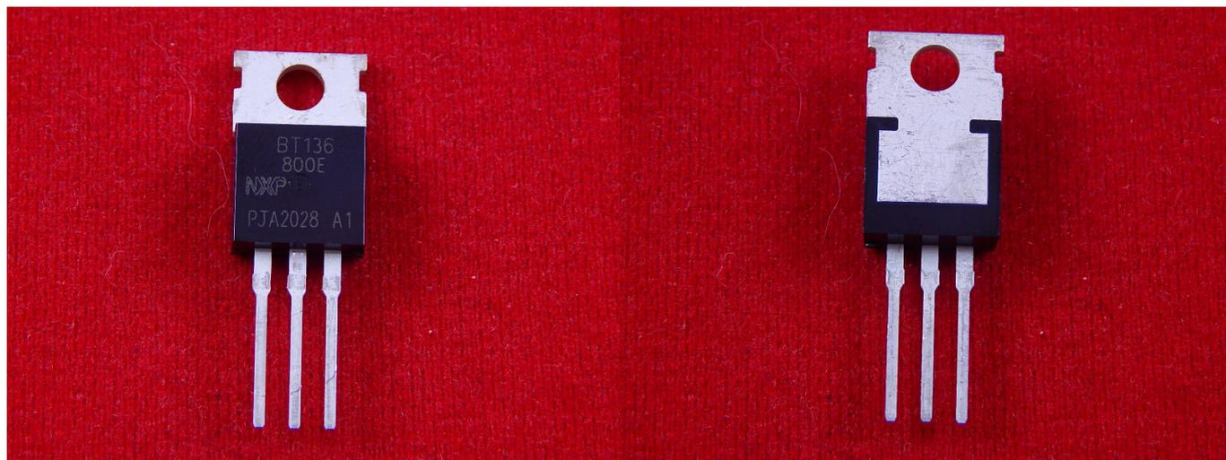
Симистор — полупроводниковый прибор, являющийся разновидностью тиристоров и используемый для коммутации в цепях переменного тока. В электронике часто рассматривается как управляемый выключатель.
