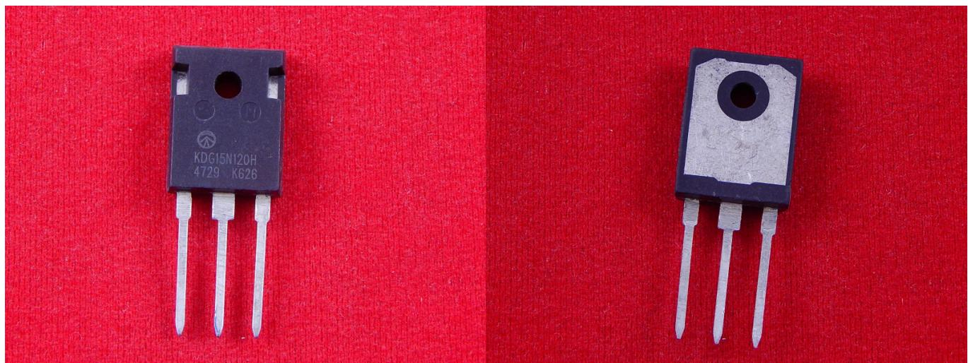
Транзистор - радиоэлектронный компонент из полупроводникового материала, обычно с тремя выводами, способный небольшим входным сигналом управлять значительным током в выходной цепи, что позволяет использовать его для усиления, генерирования, коммутации и преобразования электрических сигналов.
