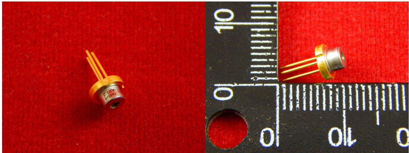
Лазерный диод — полупроводниковый лазер, построенный на базе диода. Его работа основана на возникновении инверсии населённостей в области р-п перехода при инжекции носителей заряда.
