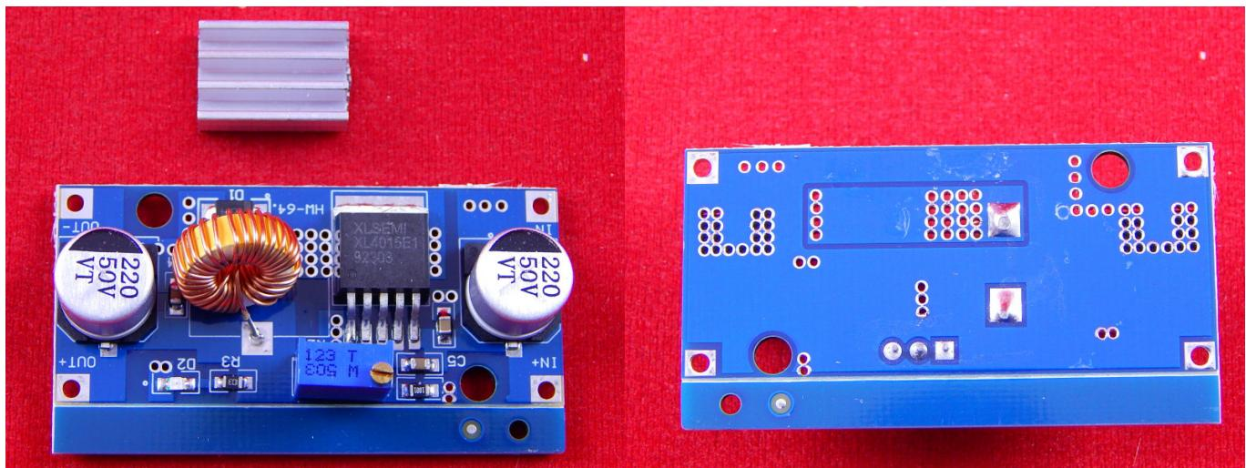
Регулируемый понижающий DC-DC преобразователь с возможностью регулировки выходного напряжения. Предусмотрены отверстия для крепления.
