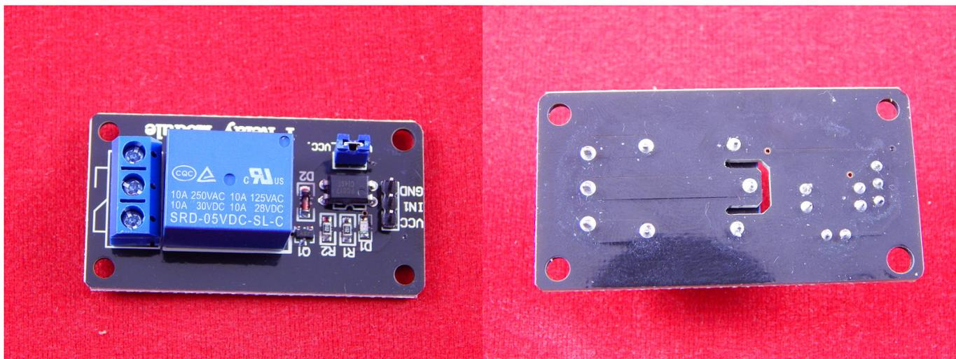
Данный модуль реле высокого уровня предназначен для управления мощным током, как постоянным, так и переменным.
