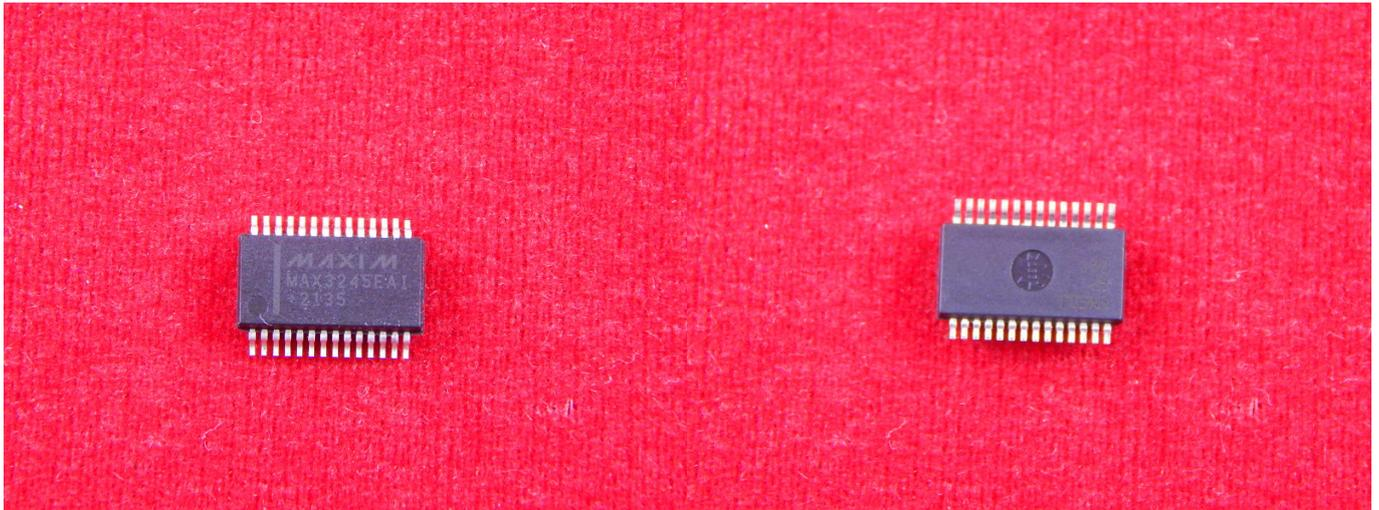
Микросхема — электронная схема произвольной сложности, изготовленная на полупроводниковой подложке и помещённая в неразборный корпус или без такового в случае вхождения в состав микросборки. Данная МАХ3245 поддерживает связь EIA/TIA-232 и V.28/V.24 с питанием 3 В.
