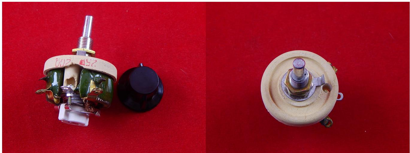
Потенциометры — это регулируемые делители напряжения, которые предназначены для регулирования напряжения при неизменной величине тока, и выполненные по типу переменного резистора.
