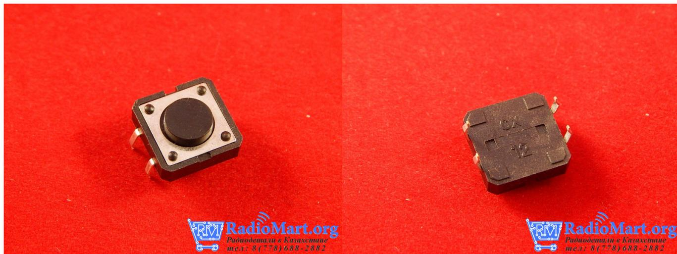
Тактовая кнопка 12x12x5мм идеально подходящая для механизмов перезагрузки и сброса устройств
