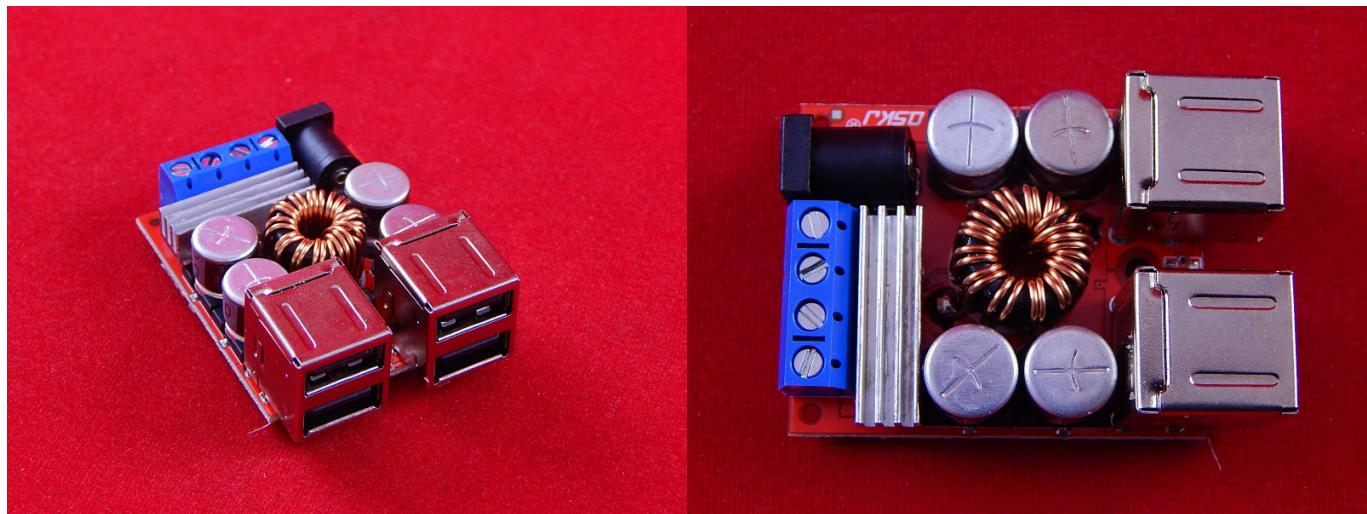
Понижающий преобразователь - вид импульсного стабилизатора напряжения, предназначенного для построения шин питания в схемах с гальванической развязкой. Выходное постоянное напряжение понижающего DC-DC конвертера не может превышать входное постоянное напряжение.
