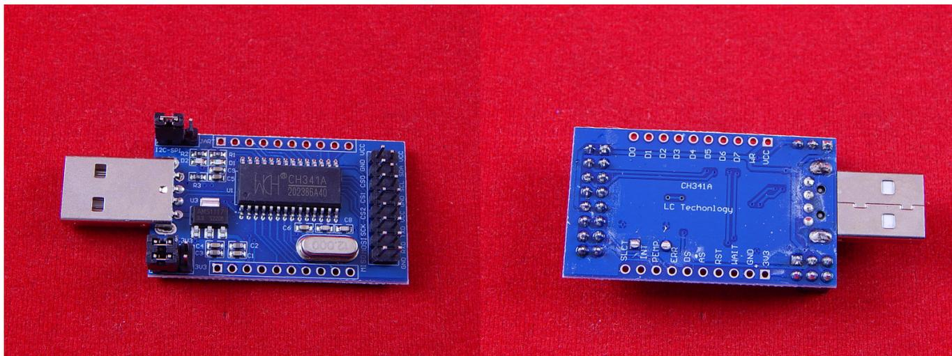
UART, пожалуй, является самым простым интерфейсом для связи какого-нибудь цифрового устройства с ПК.
