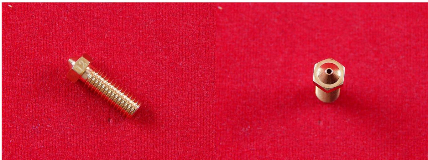
Сопло предназначено для экструдера Volcano, отличающегося более высокой производительностью. Особенностью этих деталей является увеличенная длина и большой диаметр выходного отверстия. Внутренний диаметр камеры 2 мм, он постепенно сужается к вершине головки. Увеличенная длина делает камеру расплавления нити значительно больше, что позволяет максимально увеличить темп печати.
