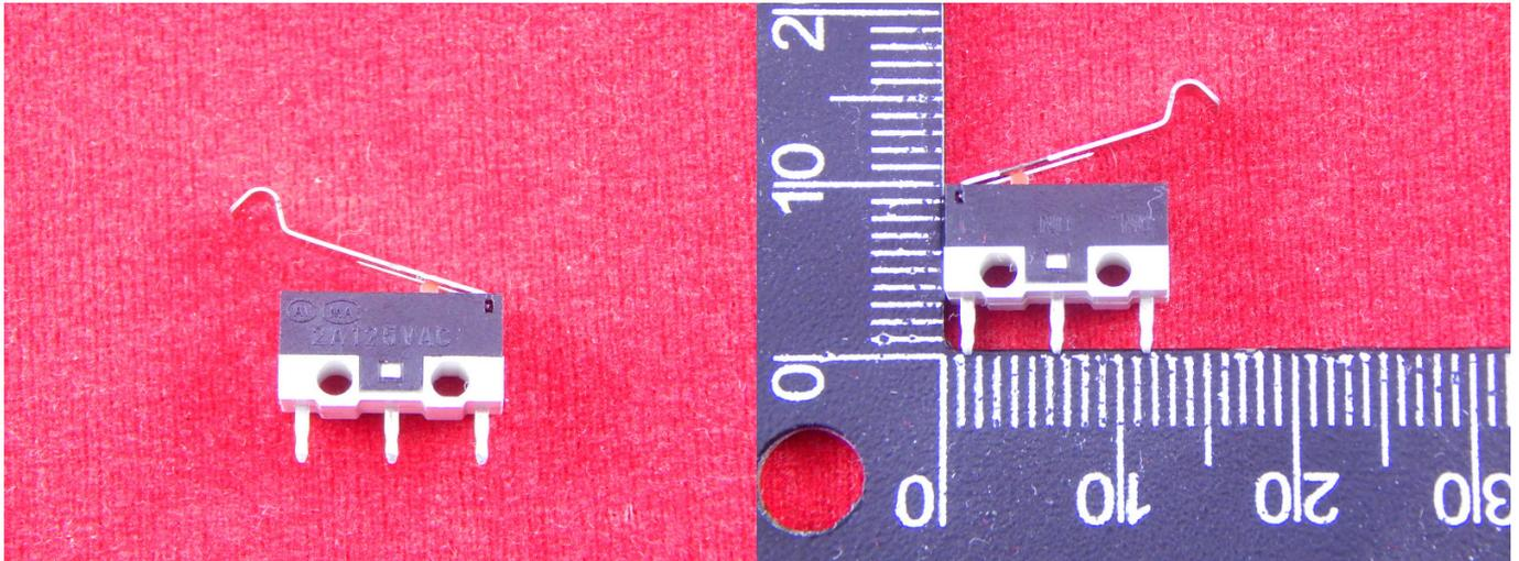
Микропереключатель DM1 - переключатель миниатюрный однополюсный, коммутирует цепи сигнализации, питания и управления с напряжением до 125В, силой тока до 2А.
