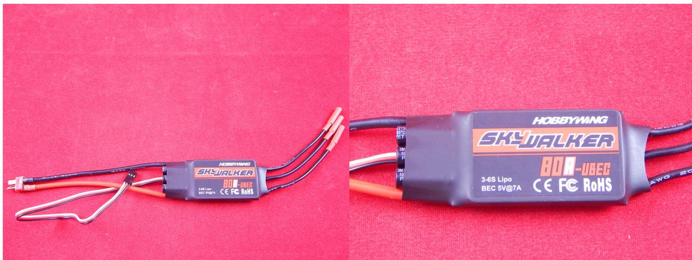
Электронный регулятор хода для бесколлекторных двигателей. Позволяет регулировать обороты двигателя с потреблением тока от 80А и до 100А. Работает от Li-xx и Ni-xx аккумуляторов к которым подключается Т-образным разъемом.
