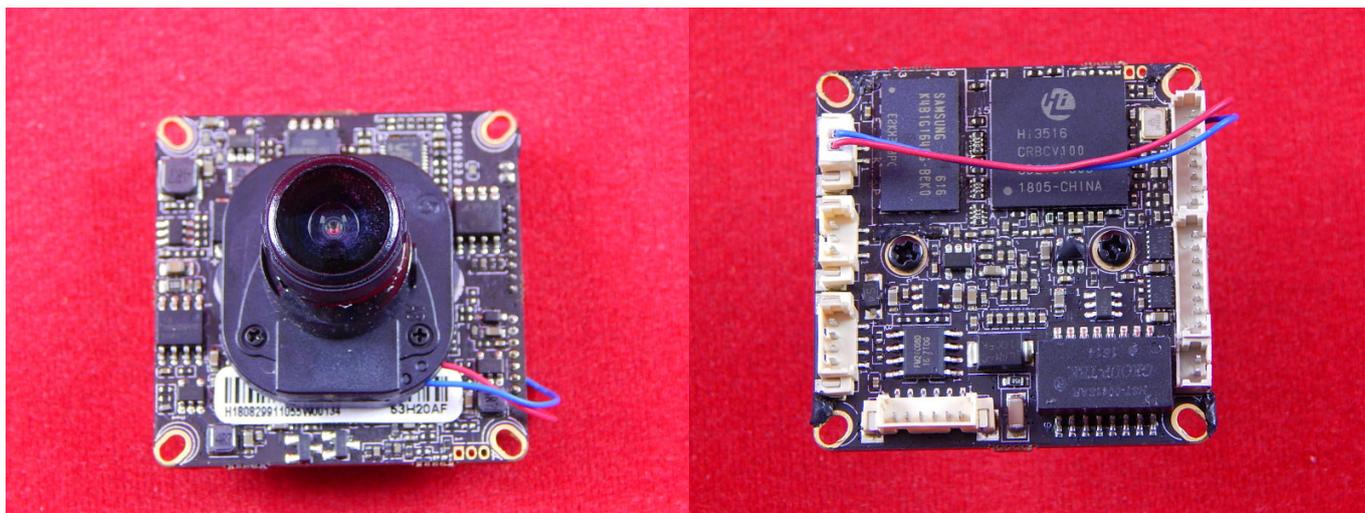
IP-камера видеонаблюдения снимает видео и транслирует видеопоток в цифровом формате с использованием сетевого протокола, обеспечивающего маршрутизацию пакетов. По сути IP-камера — камера видеонаблюдения плюс мини-компьютер. Состоит из матрицы, объектива, центрального процессора, процессора обработки, процессора сжатия, сетевого интерфейса.
