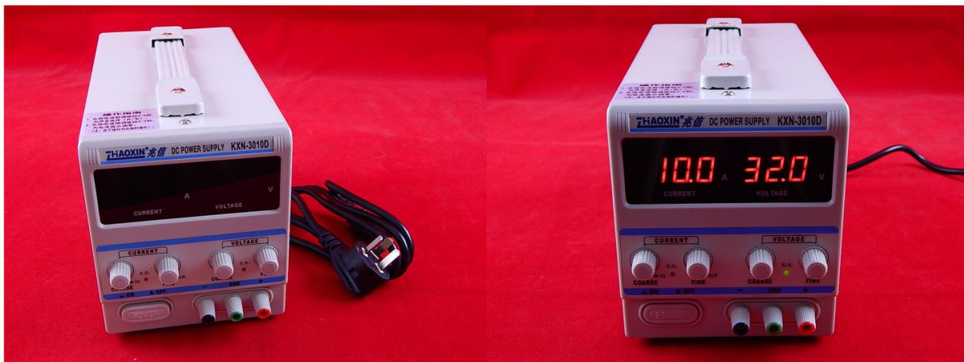
Блок питания лабораторный - это дополненный определённым набором сервисных функций блок питания. С точки зрения метрологии, это измерительный прибор, хранящий эталон как минимум одной физической величины и воспроизводящий её с целью производства электрических измерений в сопрягаемых приборах и их отладки.
