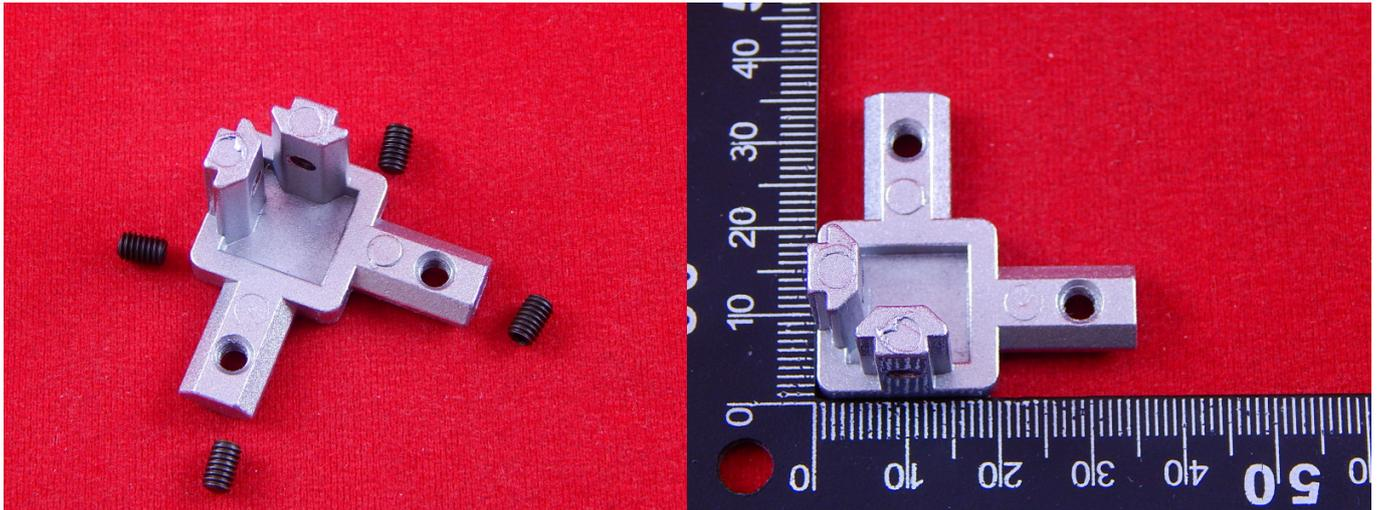
Трёхсторонний угловой соединитель к профилям серии 20, с пазом 6 мм. В комплекте ещё идут четыре стопорных винта М4х6 мм.
