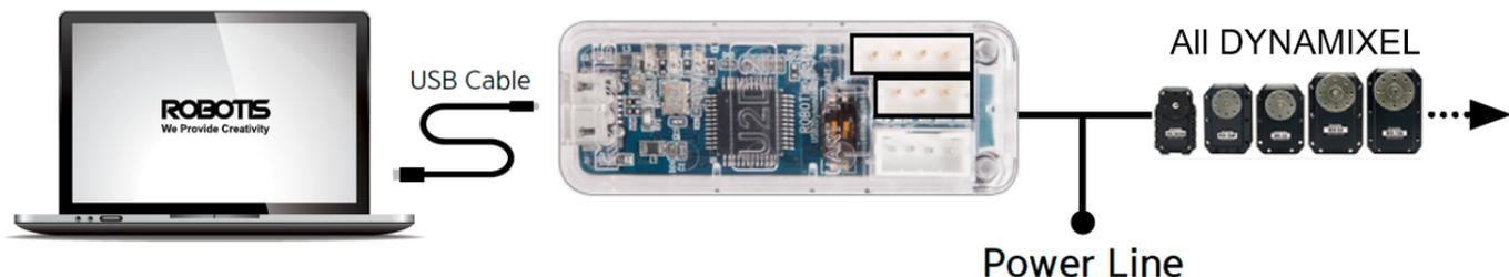
Преобразователь интерфейса имеет 3-контактный разъем для связи TTL и 4-контактный разъем RS-485. Также поддерживается UART.
