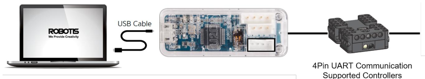
**В случае прерываний сигнала с U2D2, проверьте напряжение, подаваемое на сервопривод.**
