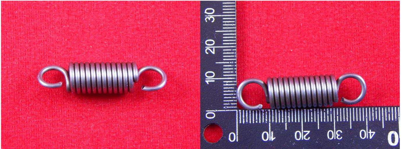
Спиралевидная пружина - это упругий элемент один из самых широко применяемых в конструкциях, приборах и различных механизмах, основная функция которого - отклоняться под действием нагрузки и восстанавливать первоначальную форму при снятии нагрузки - отдающая или поглощающая механическую энергию.
