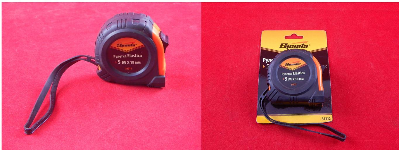
Обрешиненный корпус для защиты инструмента при падениях. Плавающий зацеп измерительного полотна обеспечивает точные измерения поверхностей. Специальное окошко в зацепе измерительного полотна позволяет использовать рулетку в качестве циркуля. Возвратная пружина усиленного типа.
