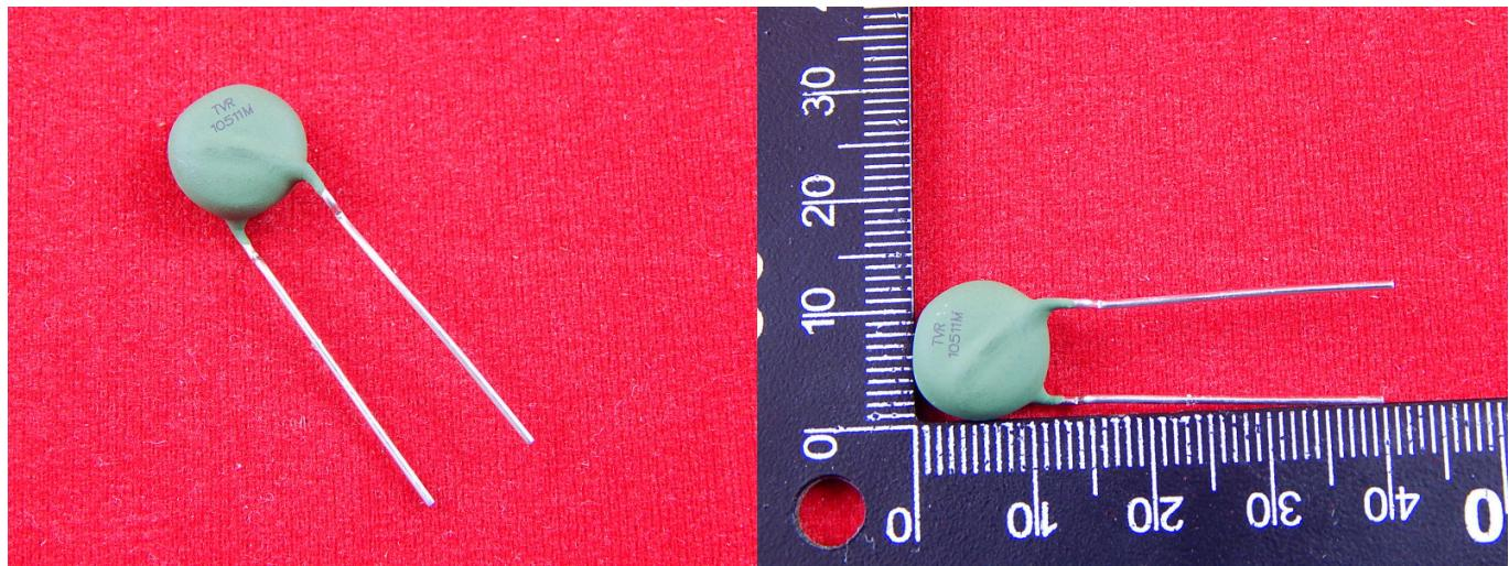
Варистор – это выполненный из полупроводникового материала переменный резистор, который способен изменять свое электрическое сопротивление в зависимости от приложенного к нему напряжения.
